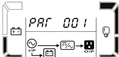
Рисунок 26 – Показания LCD-дисплея при параллельной работе ИБП
