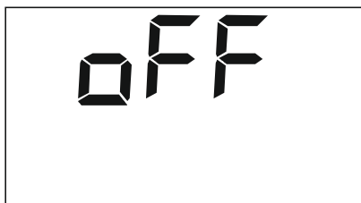
Рисунок 9 — Дисплей, напряжение питания подано
