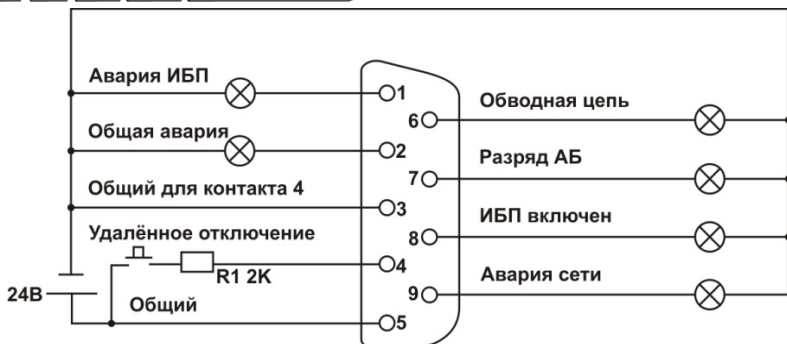
Рисунок 8 – Электрическая схема организации контроля и управления ИБП с электропитанием от источника постоянного тока напряжением +24 В
